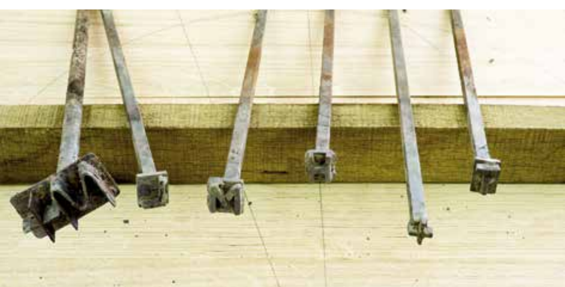
Régi, már ritkán használt besütőszerszámok. Ma már gravírozást használnak a fejlett üzemek
