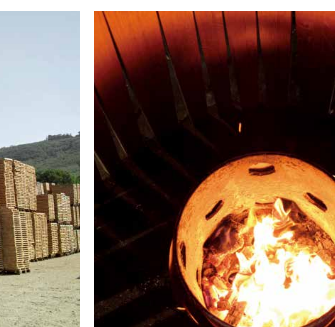
A dongafák érlelése a szabadég alatt történik
